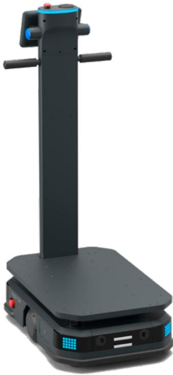
El PUDU T300 mide 134 cms de alto y pesa 60 Kg. Su batería de gran capacidad tiene una duración de entre 6h (a máxima carga) y 12h (sin carga). En un tiempo récord de 2h su batería será recargada mediante su base de carga.
